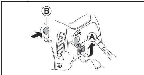
3. Približno 6-krat pritisnite membrano črpalke za gorivo (B), dokler se ta ne začne polniti z gorivom. Membrane črpalke za gorivo ni treba povsem napolniti.
