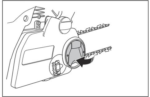
6. Stellen Sie sicher, dass sich die Sägekette leicht von Hand drehen lässt und nicht an der Führungsschiene herabhängt.
