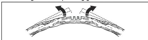
8. Sägen Sie den Baum/Ast von der anderen Seite der Biegung, nachdem die Spannung gelöst ist.
