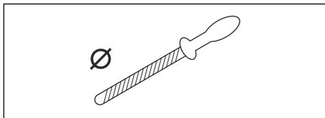
Verige ni enostavno pravilno nabrusiti brez ustrezne opreme. Uporabite priporočeno šablono za brušenje Husqvarna. Tako boste ohranili največjo učinkovitost rezanja in zmanjšali tveganje povratnega udarca.
