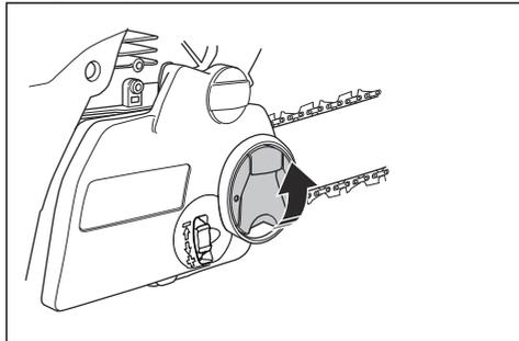
2. Gumbni vijak zavrtite v nasprotni smeri urinega kazalca, da sprostite pokrov sklopke.
