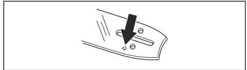
2. Prüfen Sie, ob sich an den Kanten der Führungsschiene Grate gebildet haben. Entfernen Sie Grate mit einer Feile.
