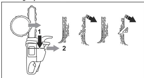
2. Spodnji smerni rez mora biti vodoraven in pod kotom  $90^{\circ}$  glede na smer podiranja.
