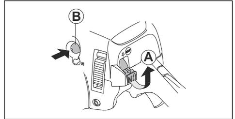
3. Drücken Sie die Kraftstoffpumpe (B) ca. 6 Mal, bis sich die Pumpe mit Kraftstoff füllt. Es ist nicht erforderlich, die Kraftstoffpumpenblase vollständig zu füllen.
