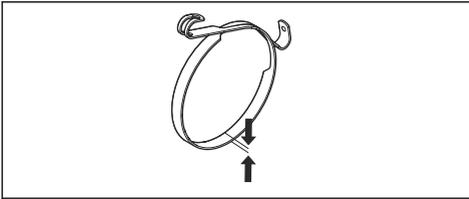
2. Prüfen Sie das Bremsband. Das Bremsband muss an der dünnsten Stelle mindestens 0,6 mm dick sein.
