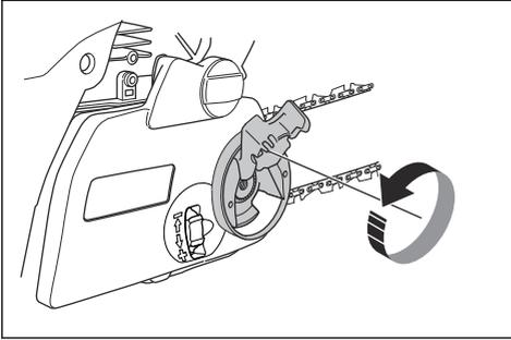
3. Drehen Sie die Kettenspannrolle nach unten (+), um die Spannung an der Sägekette zu erhöhen. Drehen Sie die Kettenspannrolle nach oben (-), um die Spannung an der Sägekette zu verringern.
