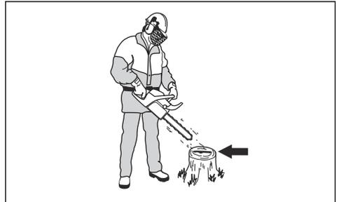
3. Wenn die Sägekettenschmierung nicht ordnungsgemäß funktioniert, führen Sie eine Prüfung der Führungsschiene durch. Eine Anleitung finden Sie in *So prüfen Sie die Führungsschiene auf Seite 36*. Wenden Sie sich an den Kundendienst, wenn Sie mit den Wartungsschritten das Problem nicht beheben können.
