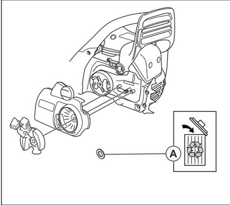
**Hinweis:** Wenn der Kupplungsdeckel nicht einfach zu entfernen ist, schrauben Sie die Schienenmutter fest, aktivieren Sie die Kettenbremse und lösen Sie sie wieder. Ein Klicken ist hörbar, wenn sie richtig gelöst wird.
