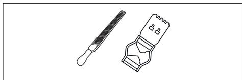
1. Nastavitve globine reza prilagodite s ploščato pilo in šablono za brušenje globinskih zob. Uporabljajte samo šablono za brušenje globinskih zob za nastavitve ustrezne globine in šablono za brušenje zelenih rezalnih zob družbe Husqvarna.
