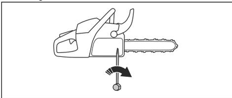
5. Ziehen Sie die Mutter der Führungsschiene mit dem Zoll-Schraubenschlüssel an, und heben Sie gleichzeitig die Vorderseite der Führungsschiene an.
