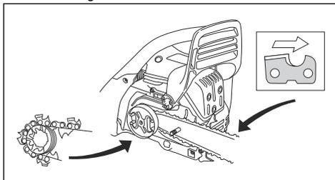
6. Richten Sie das Loch in der Führungsschiene an dem Stift der Ketteneinstellung aus, und befestigen Sie den Kupplungsdeckel.
