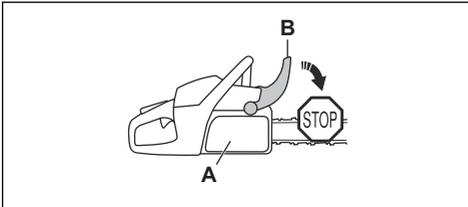
Bewegen Sie den Handschutz nach hinten, um die Kettenbremse zu lösen.
