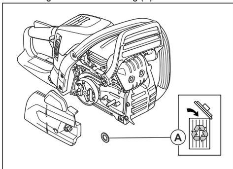
**Hinweis:** Wenn der Kupplungsdeckel nicht einfach zu entfernen ist, schrauben Sie die Schienenmutter fest, aktivieren Sie die Kettenbremse und lösen Sie sie wieder. Ein Klicken ist hörbar, wenn sie richtig gelöst wird.
