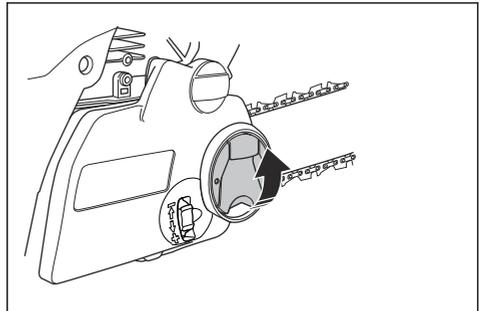
2. Lösen Sie den Kupplungsdeckel, indem Sie den Knauf gegen den Uhrzeigersinn drehen.
