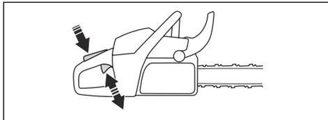
2. Pritisnite zaklep ročice plina navzdol in se prepričajte, da se vrne v začetni položaj, ko ga sprostite.
