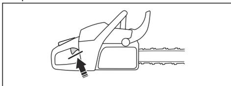
4. Zaženite izdelek in pritisnite polni plin.
