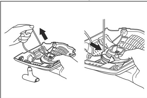
5. Entfernen Sie die mittlere Schraube, das Mitnehmerrad (A), die Mitnehmerradfeder (B) und die Riemenscheibe (C).
