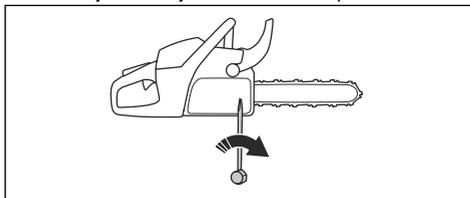
5. Z izvijačem zategnite matice meča in hkrati privzdignite sprednji del meča.
