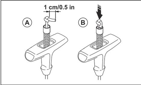
15. Ziehen Sie das Startseil, bis 1 cm der Federführung sichtbar ist. Montieren Sie gleichzeitig die Abdeckung des Starthandgriffs.
