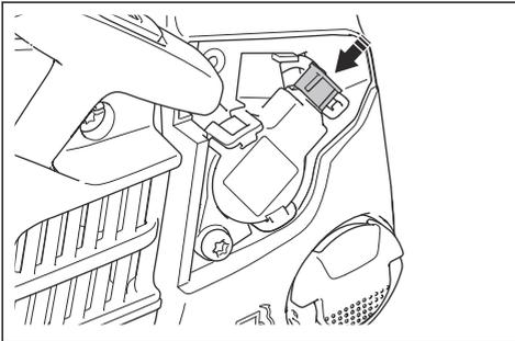
5. Installieren Sie die Kunststoffabdeckung, und ziehen Sie die Schraube fest.
