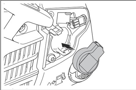
4. Installieren Sie den Verbinder am Husqvarna connectivity device.
