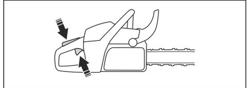
7. Bewegen Sie den Handschutz nach hinten, um die Kettenbremse zu lösen.
