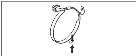
2. Preverite zavorni trak. Zavorni trak mora biti na najtanjši točki debel najmanj 0,6 mm/0,024 palca.
