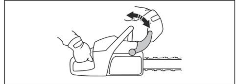
3. Halten Sie das Gerät mit beiden Händen über einen Baumstumpf oder eine andere stabile Oberfläche.
