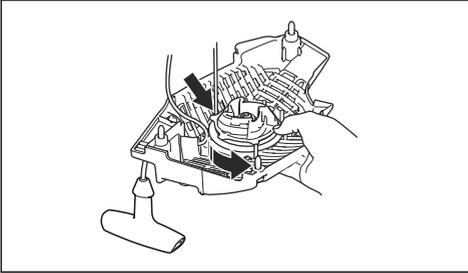
5. Entfernen Sie die Schraube und die Unterlegscheibe (A) und anschließend die Seilscheibe (B).
