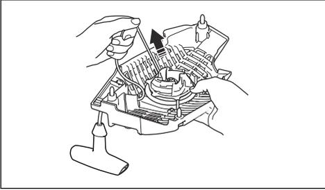
4. Lassen Sie die Seilscheibe sich langsam nach hinten drehen, um die Rückzugfeder zu lösen.
