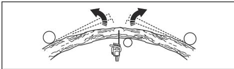
5. Machen Sie einen oder mehrere Schnitte so tief wie erforderlich, um die Spannung zu verringern. Sägen Sie am oder in der Nähe des Punktes mit der stärksten Spannung. Lassen Sie den Baumstamm oder Ast an dem Punkt mit der stärksten Spannung brechen.
