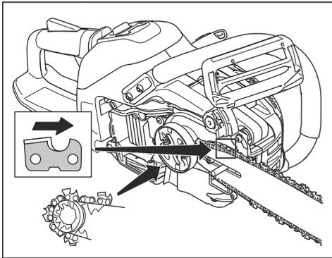
6. Richten Sie das Loch in der Führungsschiene an dem Stift der Ketteneinstellung aus, und befestigen Sie den Kupplungsdeckel.
