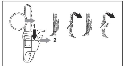
2. Stellen Sie sicher, dass der untere Kerbschnitt horizontal ausgerichtet ist und im Winkel von  $90^\circ$  Grad zur Fällrichtung ist.
