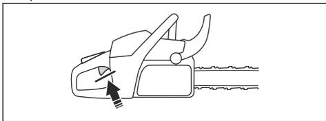
4. Zaženite izdelek in pritisnite polni plin.
