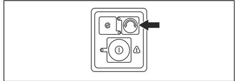
**Opomba:** Ko smer vrtenja spremenite v smer urinega kazalca, se odrezan material odstrani z noža/rezila za travo. Hitrost noža/rezila za travo se krajši čas znižuje, preden se znova začne vrtenje v nasprotni smeri urinega kazalca.
