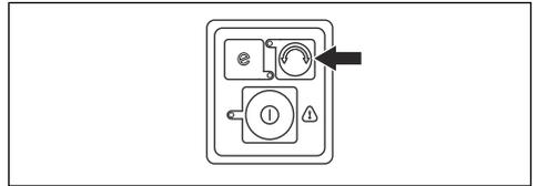
**Hinweis:** Der Trimmerfaden kann leichter herausgezogen und verlängert werden, wenn sich der Trimmerkopf im Uhrzeigersinn dreht.
