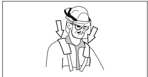
5. Stellen Sie den Tragegurt so ein, dass die Schneidausrüstung parallel zum Boden hängt.
