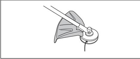
3. Ersetzen Sie den Schutz für die Schneidausrüstung, wenn er beschädigt ist.
