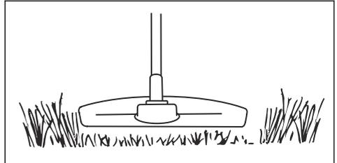
2. Drücken Sie den Trimmerkopf nicht auf den Boden. Dies kann das Gerät beschädigen.
