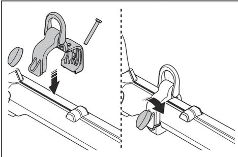
3. Schließen Sie die Enden der Schleifhalterung an.
