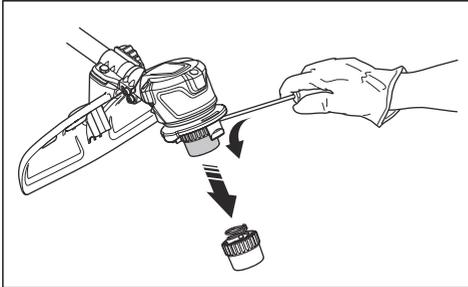
3. Entfernen Sie die Befestigungsmutter des Trimmerkopfs und das Mitnehmerrad.
