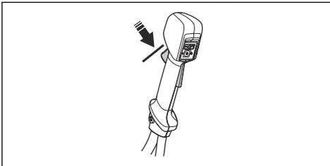
2. Die Gashebelsperre eindrücken und kontrollieren, ob sie in ihre Ausgangslage zurückkehrt, wenn sie losgelassen wird.
