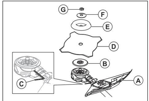
3. Montieren Sie das Mitnehmerrad (B) an der Abtriebswelle.
