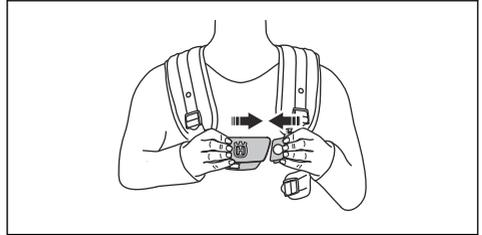
4. Wenn der Tragegurt über ein Hüftpolster und einen Hüftriemen verfügt, stellen Sie sicher, dass die Schnelllösefunktion ordnungsgemäß funktioniert.
