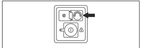
**Hinweis:** Wenn die Drehrichtung in den Uhrzeigersinn geändert wird, wird das Schnittgut von der Grasklinge/dem Grasmesser gelöst. Die Geschwindigkeit der Grasklinge/des Grasmessers verringert sich kurz, bevor sie/es sich wieder gegen den Uhrzeigersinn dreht.
