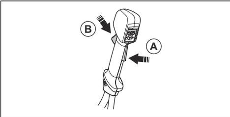
1. Kontrollieren Sie, ob der Gashebel gesperrt ist, wenn sich die Sperre in der Ausgangslage befindet.
