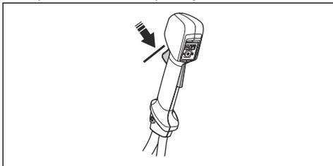
2. Pritisnite sprožilec plina in se prepričajte, da se ta po sprostitvi vrne v izhodiščni položaj.
