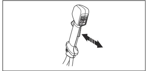
3. Prüfen Sie, ob sich der Gashebel und die Sperre frei bewegen lassen und ob die Rückholfeder ordnungsgemäß funktioniert.
