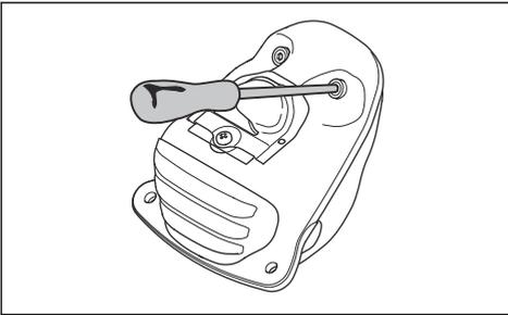
**Hinweis:** Entfernen Sie den Schalldämpfer nicht aus dem Gerät.
