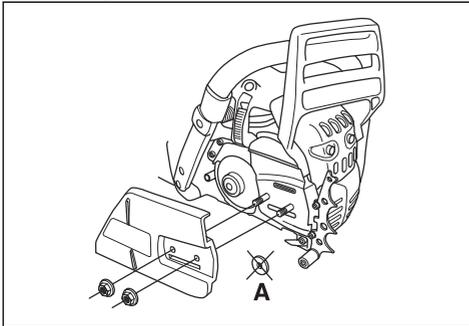
**Hinweis:** Wenn der Kupplungsdeckel nicht einfach zu entfernen ist, schrauben Sie die Schienenmutter fest, aktivieren Sie die Kettenbremse und lösen Sie sie wieder. Ein Klicken ist hörbar, wenn sie richtig gelöst wird.
