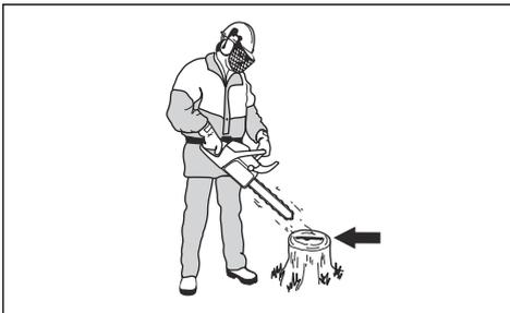
3. Wenn die Sägekettenschmierung nicht ordnungsgemäß funktioniert, führen Sie eine Prüfung der Führungsschiene durch. Eine Anleitung finden Sie in *So prüfen Sie die Führungsschiene auf Seite 32*. Wenden Sie sich an den Kundendienst, wenn Sie mit den Wartungsschritten das Problem nicht beheben können.
