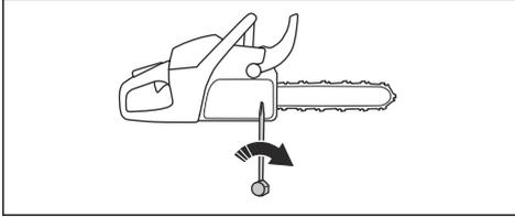
5. Ziehen Sie die Muttern der Führungsschiene mit dem Zoll-Schraubenschlüssel an, und heben Sie gleichzeitig die Vorderseite der Führungsschiene an.
