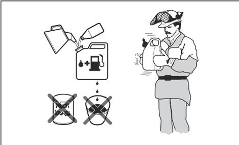
1. Füllen die Hälfte des Benzins in einen sauberen Kraftstoffbehälter.
