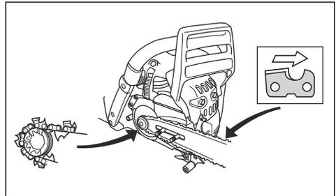
6. Richten Sie das Loch in der Führungsschiene an dem Stift der Ketteneinstellung aus, und befestigen Sie den Kupplungsdeckel.
