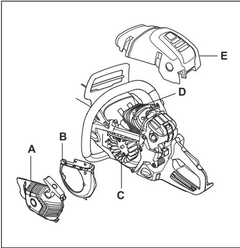
1. Reinigen Sie das Kühlsystem wöchentlich oder bei Bedarf häufiger mit einer Bürste.
