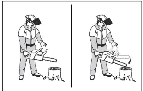
5. Stellen Sie sicher, dass die Kettenbremse aktiviert wird, sobald die Führungsschienenspitze auf dem Baumstumpf aufschlägt.
