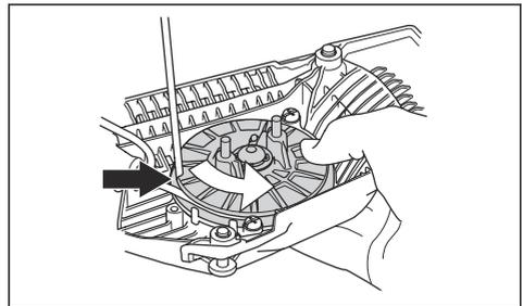
4. Lassen Sie die Riemenscheibe sich langsam nach hinten drehen, um die Rückzugfeder zu lösen.
