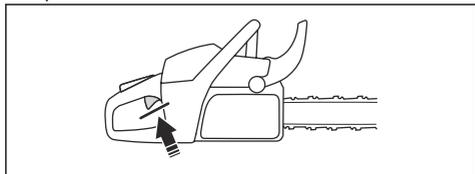
4. Zaženite izdelek in pritisnite polni plin.
