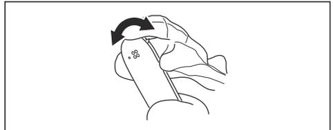
7. Drehen Sie die Führungsschiene täglich zur Verlängerung der Lebensdauer.
