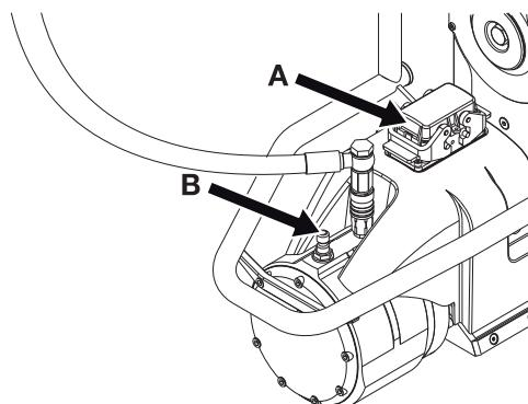
Une fois le câble d'alimentation branché à la scie, le mousqueton situé sur le câble doit être fixé à l'ensemble de scie afin d'éviter toute pression sur la prise pendant le fonctionnement. Le mousqueton doit être fixé à l'un des œilletons de support de la poignée, vissée à l'arrière du moteur d'entraînement.
