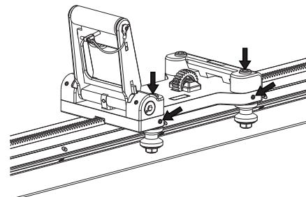
Faites tourner les arbres délicatement à l'aide d'une clé mixte de 16 mm, jusqu'à ce que les roues de guide reposent contre le rail.
