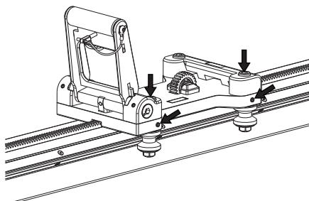
Gire levemente los ejes con una llave de 16 mm hasta que las ruedas guía reposen sobre el riel.
