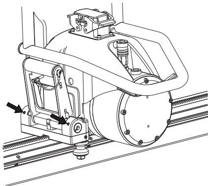
Drehen Sie die beiden Excenterhülsen mit einem 8-mm-Inbusschlüssel, bis die Welle fest sitzt und parallel zur Schneideeinheit ausgerichtet ist.
