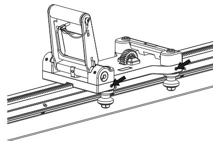
Appuyez sur le dispositif de blocage et tirez manuellement le chariot de scie dans les deux sens. Le chariot doit glisser facilement, en rencontrant une légère résistance. Les 4 roues de guide doivent tourner.
