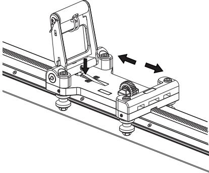
Ziehen Sie die Schrauben mit einem 8-mm-Inbusschlüssel fest. Wiederholen Sie den vorherigen Schritt.
