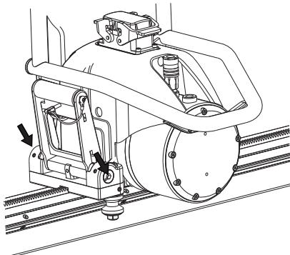
Serrez les deux vis supérieures à l'aide d'une clé à six pans de 3 mm.
