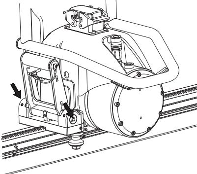
Ziehen Sie die beiden Anschlagschrauben mit einem 3-mm-Inbusschlüssel fest.
