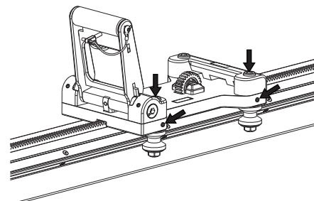
Drehen Sie die Welle vorsichtig mit einem 16-mm-Schraubenschlüssel, bis die Führungsräder auf der Schiene aufliegen.
