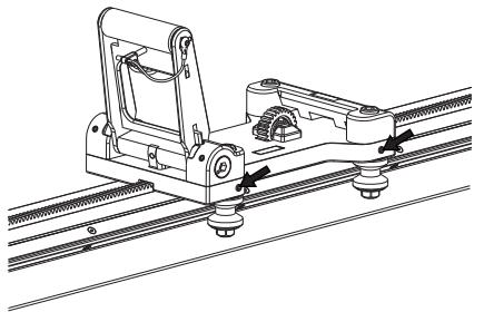
Presione el dispositivo de bloqueo y tire manualmente del soporte de la sierra en ambas direcciones. El soporte debería deslizarse fácilmente, sin apenas oponer resistencia. Deberían girar las cuatro ruedas guía.
