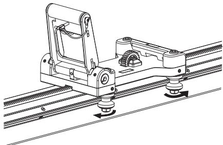
Mantenga la posición de la llave de 16 mm y apriete los dos tornillos limitadores con una llave Allen de 3 mm.
