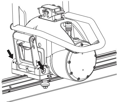
Apriete los dos tornillos limitadores con una llave Allen de 3 mm.
