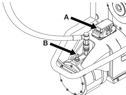
Una vez conectado el cable a la sierra, debe conectarse el mosquetón del cable a la sierra para evitar presión en el enchufe durante el funcionamiento. El mosquetón debe fijarse a uno de los orificios del soporte de la manivela atornillada a la parte posterior del motor de accionamiento.
