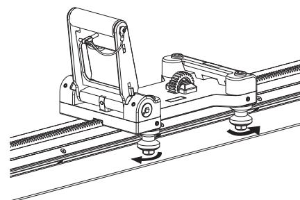
Halten Sie den 16-mm-Schraubenschlüssel in Position und ziehen Sie die beiden Anschlagschrauben mit einem 3-mm-Inbusschlüssel fest.
