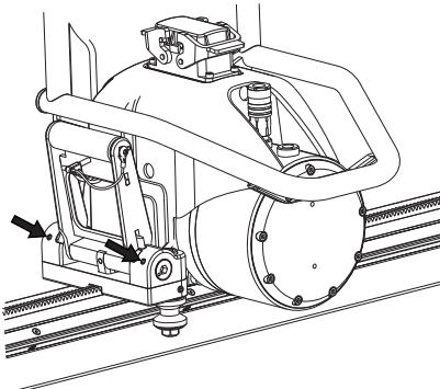
Prüfen Sie durch Öffnen und Schließen des Sperrgriffs, dass dieser korrekt eingestellt ist, und vergewissern Sie sich, dass sich die federgespannte Arretierung in der verriegelten Position befindet.
