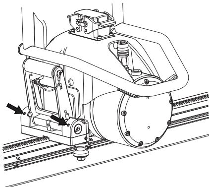
Faites tourner les deux manchons excentrés à l'aide d'une clé à six pans de 8 mm, jusqu'à ce que l'arbre soit serré et parallèle à l'ensemble de scie.
