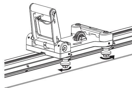
Maintenez la clé mixte de 16 mm en position et serrez les deux vis d'arrêt à l'aide d'une clé à six pans de 3 mm.
