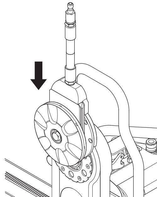
5 Tournez le moyeu de la bride de lame délicatement de façon à ce qu'il glisse dans l'un des rails du bras pivotant et atteigne la position adéquate pour pouvoir être vissé.
