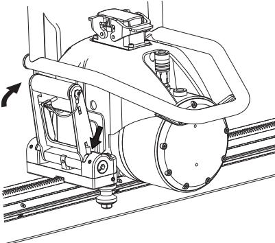
Sicher Sie den Sperrgriff anschließend mit dem Sperrstift.
