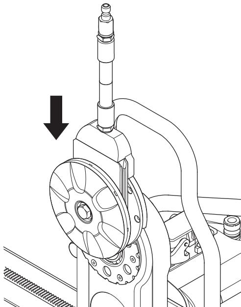
5 Gire cuidadosamente el cubo de brida de disco de manera que se deslice en uno de los rieles del brazo pivotante y alcance la posición correcta para atornillarlo.
