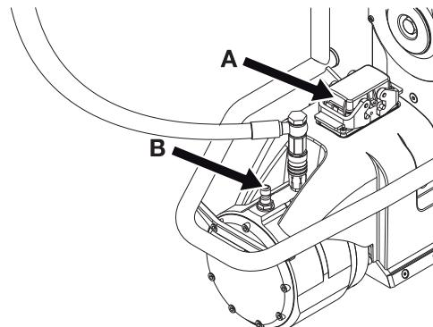
Sobald das Stromversorgungskabel an die Säge angeschlossen wird, muss der Karabiner an der Schneideinheit befestigt werden, damit der Stecker im Betrieb nicht druckbelastet ist. Der Karabiner muss an eine der Halteösen am Griff befestigt werden, der an die Rückseite des Antriebsmotors geschraubt ist.
