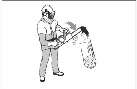
Verwenden Sie die Kettenbremse als Feststellbremse, wenn Sie das Gerät starten und sich über kurze Strecken bewegen. Dadurch reduzieren Sie das Risiko, dass Sie selbst oder Umstehende von der Sägekette erfasst werden.
