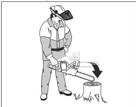
5. Stellen Sie sicher, dass die Kettenbremse aktiviert wird, sobald die Führungsschiene auf dem Baumstumpf aufschlägt.
