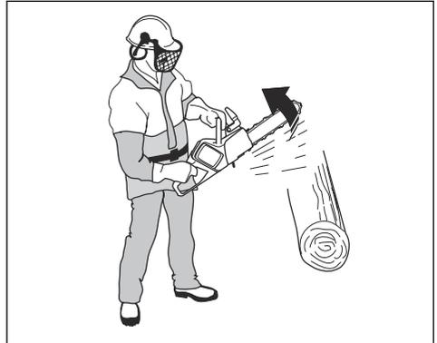
Do povratnega udarca pride samo, če se območje povratnega udarca meča dotakne predmeta. Ne dopustite, da se območje povratnega udarca dotakne predmeta.
