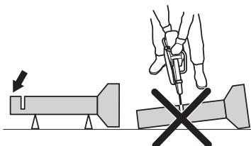
Ako se dopusti da se cijev opusti i zatvoriti rez, nož će biti priklješten u zoni povratnog trzaja i može doći do jakog povratnog trzaja. Ako je cijev pravilno učvršćena, kraj cijevi će se pomjeriti prema dolje, rez će se otvoriti i neće biti priklještenja.
