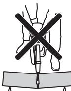
Ako se nož zaglavi ili zaustavi u zoni povratnog trzaja, motorni čistač će se usled reaktivne sile odbaciti i okrenuti unazad prema korisniku što dovodi do ozbiljnih ili čak fatalnih povreda. Pazite na moguće pokrete komada koji obrađujete. Ako komad koji obrađujete nije pravilno pričvršćen i pomeri se tokom sečenja, on može uštinuti sečivo i izazvati povratni trzaj.
