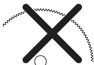
Ako koristite motorni rezac sa noževima s karbidnim vrhom, kršite sigurnosne propise rada.
