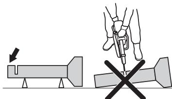
Ako se cijev ulegne i zatvori rez, rezna ploča će se zaglaviti u području povratnog trzaja i može doći do ozbiljnog povratnog trzaja. Ako je cijev pravilno poduprta kraj cijevi će se pomaknuti prema dolje, rez će se otvoriti i neće doći do uglavljivanja rezne ploče.
