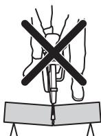
Ako je disk priklješten ili zaustavljen u području povratnog trzaja, reakciona sila će gurati motorni režac prema gore i nazad prema korisniku u rotirajućem pokretu, uzrokujući ozbiljne ili smrtonosne povrede. Pazite na potencijalno pomjeranja komada s kojim se radi. Ako komad s kojim se radi nije pravilno oslonjen i pomjera se prilikom rezanja, moguće je da će priklještiti nož i izazvati povratni trzaj.
