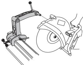
**PREVIDNO!** Tirni nosilec morate najprej namestiti na tirnico, preden namestite brusilni rezalnik na tirni nosilec. S tem zagotovite, da je nosilec na tirnico pritrjen pod pravimi koti.
