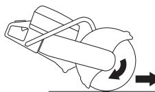
Nikada ne pomjerajte mašinu dok se rezni pribor okreće. Žiroskopske sile mogu da ometaju namenjeno kretanje.
