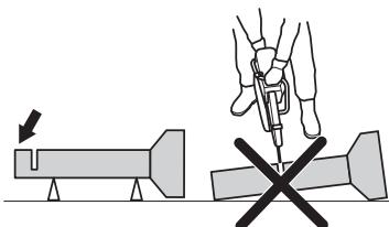
Če se pipa povesi in zapre rez, bo pritisnila na rezilo v območju povratnega udarca in lahko pride do močnega povratnega udarca. Če je cev pravilno podprta, se bo konec cevi spustil, rez se bo odprt in ne bo prišlo do pritiskanja na rezilo.
