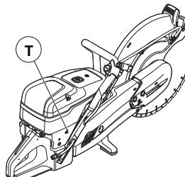
Priporočeno število vrtljajev motorja v prostem teku: 2700 rpm
