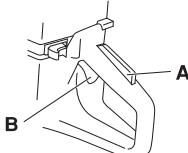
Bravica zatvarača gasa ostaje pritisnuta prema dolje sve dok je pritisnut gas. Kad se stisak ruke na ručku otpusti vraćaju se i regulacija gasa i kočnica regulacije gasa u svoje odnosne prvobitne položaje. To se dešava preko dva, međusobno nezavisna, sistema povratnih opruga. Taj položaj znači da je regulacija gasa automatski zaključena.
