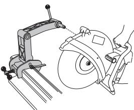
**NAPOMENA!** Tračni sklop mora se prvo pričvrstiti na tračnicu, prije nego što se motorni sjekač pričvrsti na njega. Ovo činite kako biste osigurali pričvršćivanje sklopa na tračnicu pod ispravnim uglovima.
