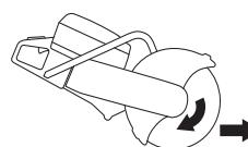
Nipošto nemojte pomicati stroj dok se rezna oprema okreće. Žiroskopske sile mogu ometati željeno kretanje.
