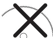
Uporaba tega brusilnega rezalnika skupaj z rezilom s karbidnim rezilom je jasna kršitev delovno-varnostnih predpisov.
