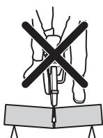
Ako je rezna ploča uklijestena ili je zapela u području povratnog trzaja, otklonska sila će gurnuti motorni rezač uvis i u kružnom kretanju ga vratiti natrag prema korisniku, izazivajući ozbiljne ili čak smrtonosne ozljede. Budite oprezni i pripazite na pomicanje materijala koji obrađujete. Ako materijal nije pravilno uglavljen i pomiče se prilikom rezanja, mogao bi zaglaviti reznu ploču i uzrokovati povratni trzaj.
