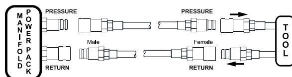
Wenn die Hydraulikschläuche (7,5 m/25 Fuß) leer sind, müssen ca. weitere 1,8 l (2 qt) Öl in den Öltank gefüllt werden, nachdem das Aggregat zum ersten Mal betrieben wurde. Wenn ein zusätzlicher Schlauchsatz von 30 m (100 Fuß) mit einem Durchmesser von 5/8 Zoll verwendet wird, müssen ca. weitere 12 l (3,2 gal) Öl hinzugefügt werden.
