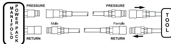
Als de hydraulische slangen (7,5 m/25 ft) leeg zijn, moet er nog ongeveer 1,8 liter (2 quart) olie aan de olietank worden toegevoegd nadat de voedingseenheid voor het eerst is gebruikt. Als er een extra slang van 16 mm (5/8") met een lengte van 30 meter (100 ft) wordt gebruikt, moet er nog ongeveer 12 liter (3,2 gal) olie worden toegevoegd.
