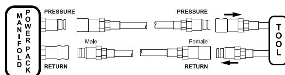
Si les tuyaux hydrauliques (7,5 m/25 ft) sont vides, il faut rajouter environ 1,8 litres (2 qt) d'huile dans le réservoir d'huile après la première utilisation de l'unité électrique. Si un jeu de tuyau 5/8" supplémentaire de 30 mètres (100 ft) de long est utilisé, il faut rajouter environ 12 litres (3,2 gal).
