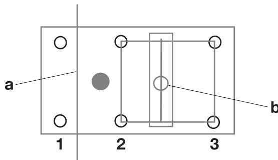
Ukoliko je to neophodno, montirajte točkove remenice kako biste olakšali proces rezanja. Kada se koriste točkovi remenice, broj oštih uglova oko kojih žica treba da se vuče može da se smanji, što kao rezultat ima manje habanje žice i, istovremeno, lakše rezanje. Pored toga, upotreba točkova remenice omogućava usmeravanje žice u različitim pravcima bez premeštanja jedinice testere.
