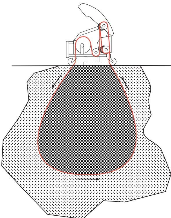
Možda će biti potrebno izbušiti rupe za provlačenje žice kroz materijal koji treba rezati.
