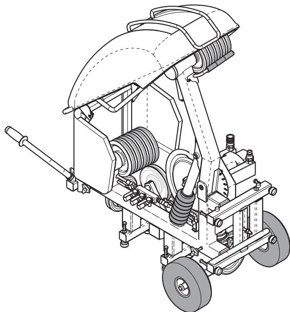
Husqvarna CS 2512 je namijenjena za upotrebu s hidrauličnom jedinicom PP 455 E ili Husqvarna RC 455. Husqvarna CS 2512 je snažna i praktična žičana pila s kapacitetom za obavljanje teških radova, ali je istovremeno dovoljno kompaktna i mobilna za obavljanje manjih radova. Može se koristiti na mnogo različitih načina, postavljena na tlo ili pričvršćena na zid.
