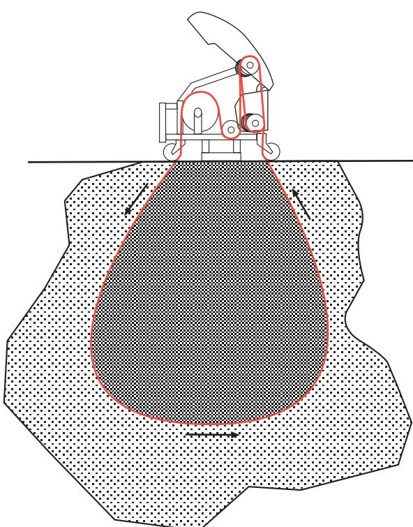
Možda će biti neophodno probušiti rupe da se provuče žica kroz materijal koji se reže.
