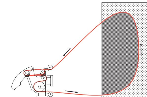
Testera se montira horizontalno kada treba da se vrši rezanje u nivou poda i kada se reže pod.
