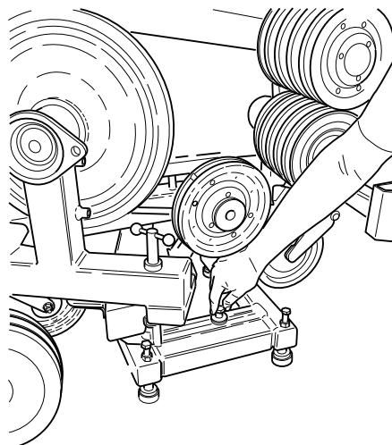
Imajte na umu da se centar težine mašine (sivi krug) nalazi između prvog i drugog para podesivih nožica (parovi podesivih nožica su označeni brojevima 1–3) s vodoravnim rezom (A). Kada rezete ispod mašine, važno je da je pila dobro pričvršćena sidrenim šaraform (b) jer se moraju koristiti parovi podesivih nožica 2 i 3. (Par podesivih nožica 1 može biti na kratkom dijelu.) Ako pila nije dobro pričvršćena, prevrnut će se kada se materijal koji podržava par podesivih nožica 1 proreže.
