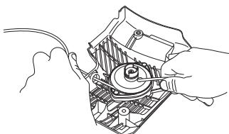
Vrvico zaganjalnika pritrdite okrog pesta na kolutu, kot prikazuje slika. Dobro zategnjte pritrdilo in zagotovite, da je prosti konec čim krajsi. Konec vrvice zaganjalnika pritrdite v ročico zaganjalnika.
